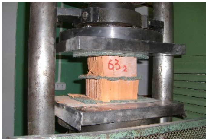
Рисунок 1. – Образец кирпича ( a ) и установка для испытаний кирпича ( б )
