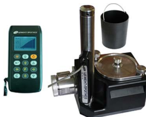
Рисунок 4. – Прибор для определения активности цемента
