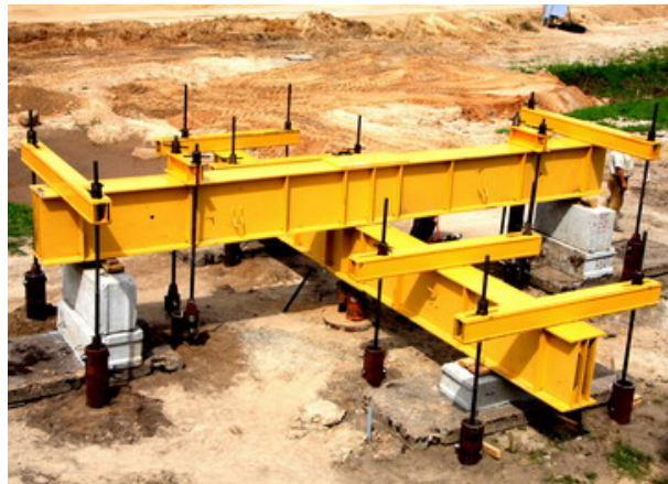
Рисунок 6. – Загрузочный стенд для испытания свай при вдавливающих нагрузках
