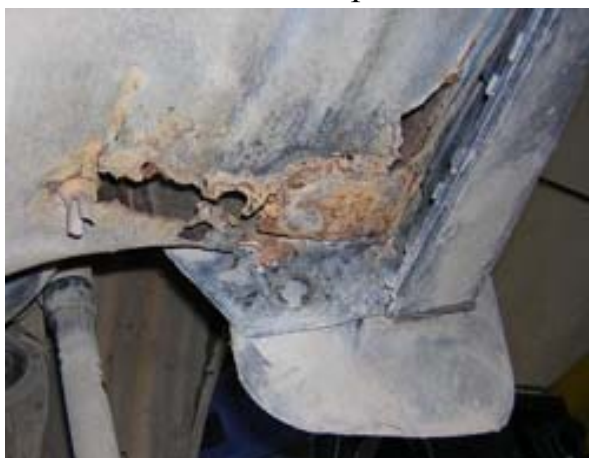
Рисунок – Предельное состояние цистерны ПА: потеря герметичности основного конструктивного элемента
