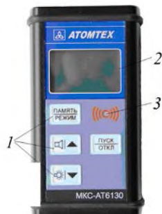
Рис. 2. Общий вид дозиметра-радиометра МКС-АТ6130: 1 – мембранная панель управления; 2 – жидкокристаллический индикатор (ЖКИ); 3 – светодиодный индикатор
