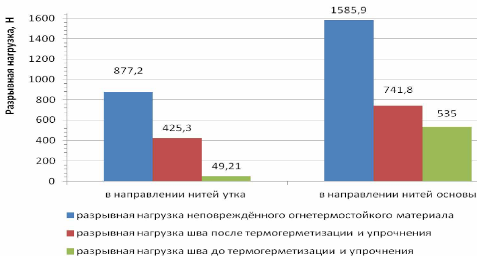
Рисунок 1. – Изменение разрывной нагрузки шва до и после упрочнения и термогерметизации соединений ОСЗ ПТВ тяжелого типа
