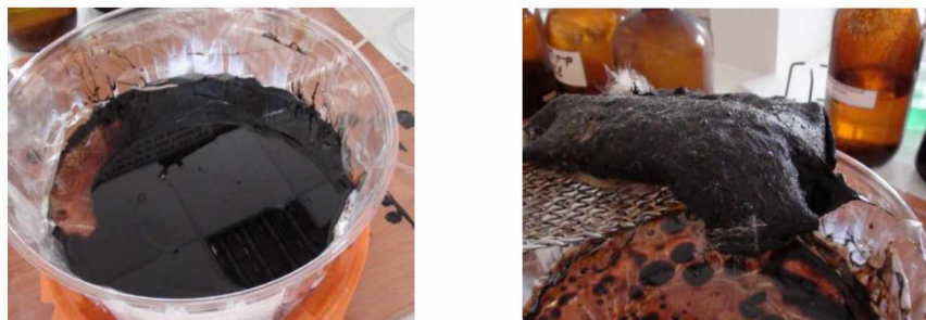
Рисунок 2. – Извлечение насыщенной нефтью порции пуха початков рогоза
