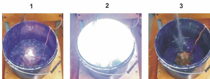
Рисунок 1. – Последовательные фазы частотного электрогидравлического воздействия на фрагмент железобетонной плиты находящейся в емкости с водой: 1 – начало процесса, 2 – максимальная фаза, 3 – финальная фаза
