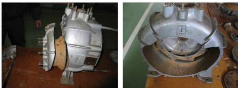
Рисунок 1 – Разрушение пожарного насоса вследствие гидроудара
