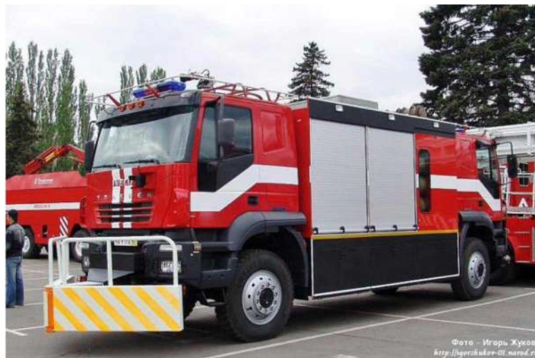
Рис. 3. Аварийно-спасательный автомобиль «Тоннель» с системой орошения
