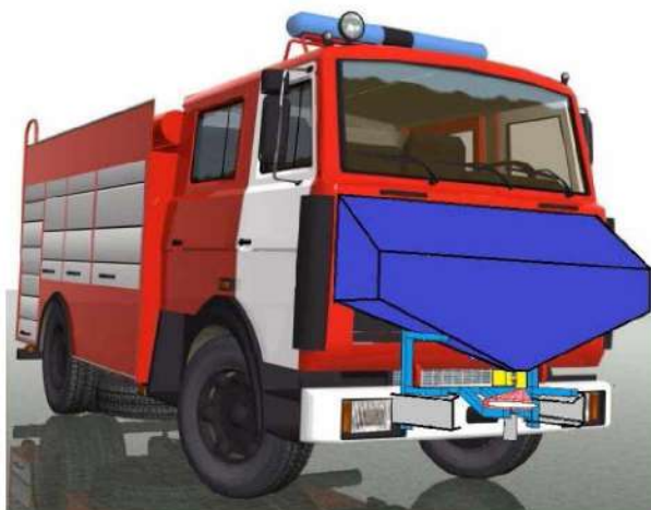
Рис 1. Внешний вид расположения разбрасывателя сорбента на пожарном аварийно-спасательном автомобиле
