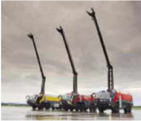
Рисунок 3 – Работа установки Stinger с полностью вытянутой гидрофицированной стрелой
