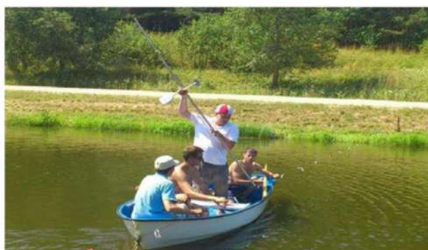
Рис 3. Замеры скоростей при помощи гидрометрической вертушки.
