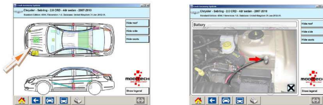
Рис. 2. Месторасположение АКБ в автомобиле и способ отключения
