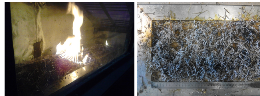
Рисунок 1 – Экспериментальные исследования процесса распространения пламени по слою опавшей сосновой хвои
