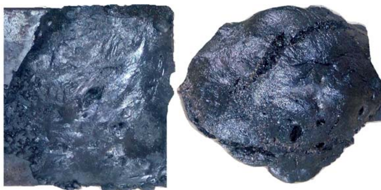
Рисунок 2 – Образцы испытания огнезащитных вспучивающихся покрытий
