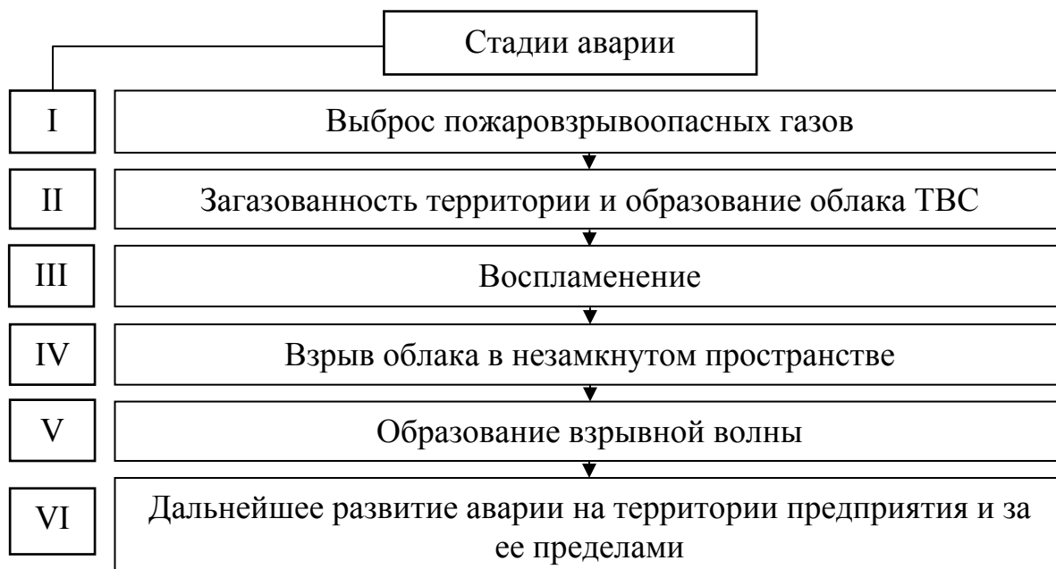
Рис. 1 – Примерные стадии развития аварии с выбросом горючих газов
