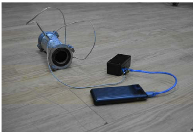
Рисунок 1 – Измерительный комплекс с рукавными вставками различного диаметра DN50, DN65, DN 80
