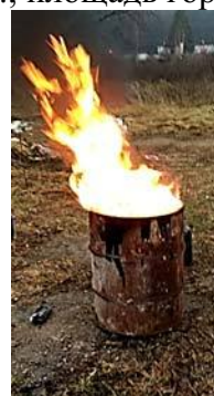
Рисунок 1 – Горение отработанного масла на площадях 23,75 см 2 (лабораторные исследования) и 2641 см 2 (полевые исследования) соответственно
