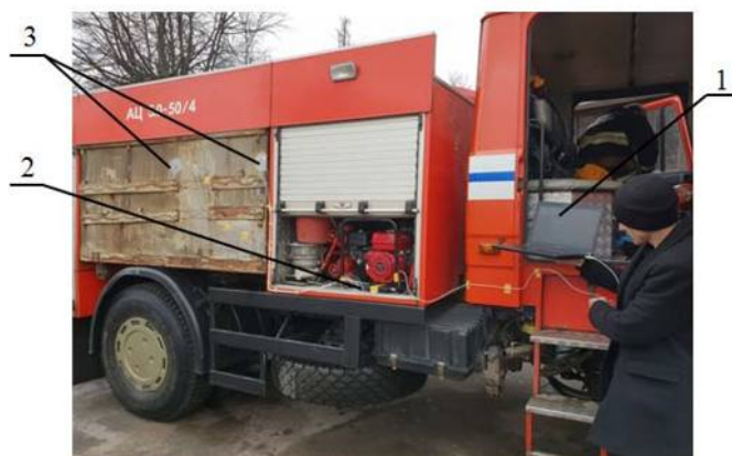
Рисунок 1 – Расположение измерительного комплекса на пожарном автомобиле:
