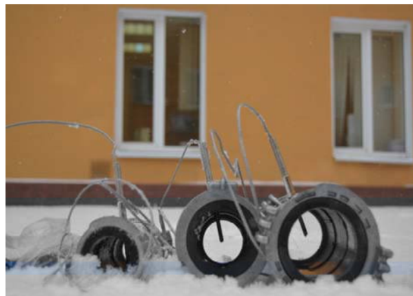
Рисунок 1 – Измерительный комплекс с рукавными вставками различного диаметра DN50, DN65, DN 80
