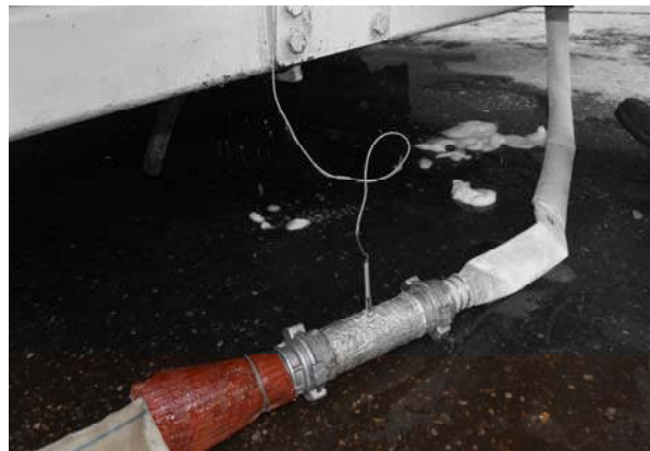
Рисунок 3 – Исследование поведения компрессионной пены при подаче по рукавным линиям
