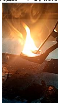
Рисунок 1 – Горение отработанного масла на площадях 23,75 см 2 (лабораторные исследования) и 2641 см 2 (полевые исследования) соответственно
