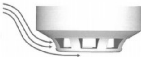
Рисунок 3 – Типовой корпус извещателя
